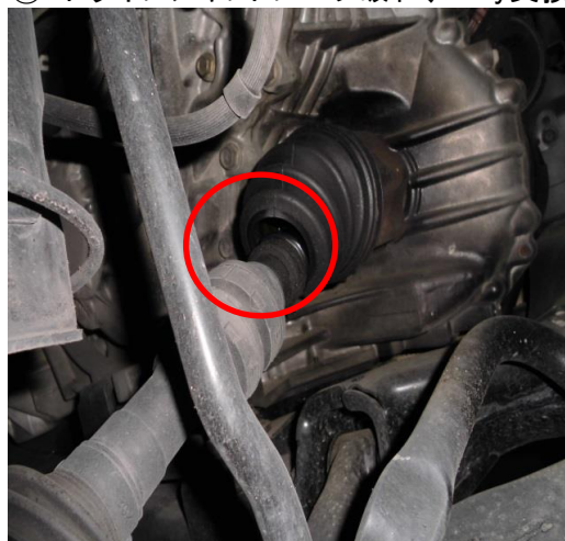
⑥ ドライブシャフトブーツ破れ、Assy交換
