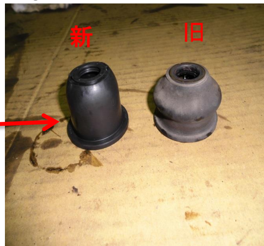
⑥ロアボールジョイントブーツの交換
